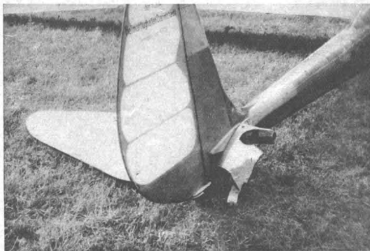
Das ist der Höhensteuerbruch. Die ganze rechte Seite der Steuerfläche ist weggerissen.
